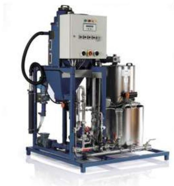
**El sistema de dosificación PolyRex es una estación de preparación de doble nivel para la preparación de polímeros líquidos y en forma de polvo. Está formado por la unidad de mezcla y la unidad de bombeo, así como por los dos depósitos de acero inoxidable. Los polímeros empleados se aprovechan de forma óptima.**
