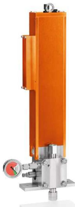
La ORLITA Evolution mikro es una bomba innovadora para la dosificación de cantidades muy reducidas a alta presión. Esta bomba dosificadora de membrana hidráulica es la primera de su clase con accionamiento directo lineal regulado electrónicamente. El accionamiento presenta pocos elementos funcionales mecánicos, por lo que está prácticamente exento de mantenimiento.
