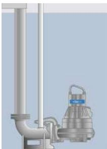
Instalación semipermanente en pozo húmedo. La bomba se instala con barra guía doble en una conexión de descarga.
