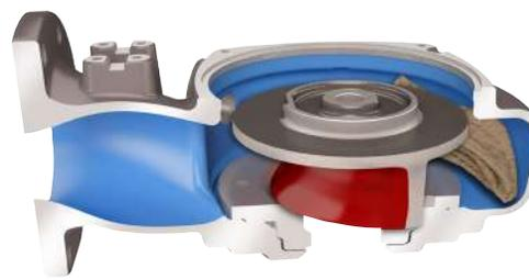
**2a. etapa.** El objeto sólido se desplaza a lo largo de la punta del álabe, dentro de la ranura. El guide pin en el anillo insertado aparta todos los fragmentos sólidos del centro del impulsor, a lo largo del borde de ataque y a través de la ranura.
