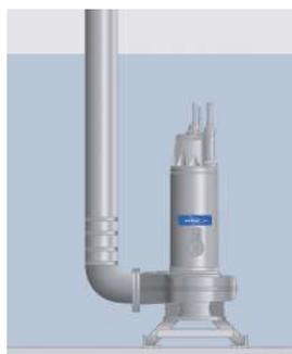
Instalación semipermanente, independiente. Versión transportable, con conexión a tubería o manguera.
