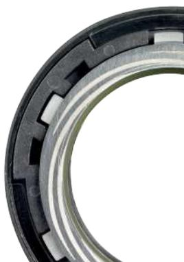
Active Seal™ es un sistema patentado de cero penetración de líquido que impide de forma activa las filtraciones de líquido en la cavidad del motor, reduciendo el riesgo de averías en el rodamiento y el estator. Consta de una excepcional junta interior que actúa como microbomba, y una junta exterior que impide la entrada del líquido bombeado en la cámara intermedia.
