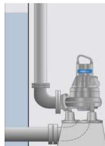
Instalación vertical permanente en pozo seco, o en línea, con conexión embridada a tuberías de aspiración y descarga.
