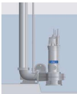
Instalación semipermanente en pozo húmedo. La bomba se instala con barra guía doble en una conexión de descarga.
