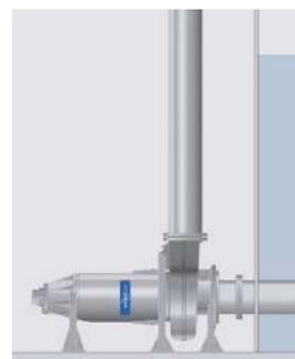
Instalación horizontal permanente en pozo seco, o en línea, con conexión embrizada a tuberías de aspiración y descarga.
